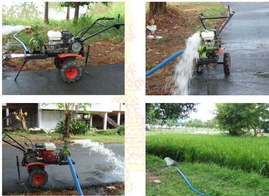
ภาพที่ 6 ลักษณะการทำงานของปั้มน้ำดีตรถไถเดินตาม
