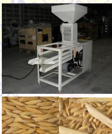
ภาพที่ 1 ลักษณะของเครื่องผัดทำความสะอาดและข้าวเปลือกที่ได้จากการทำความสะอาด
