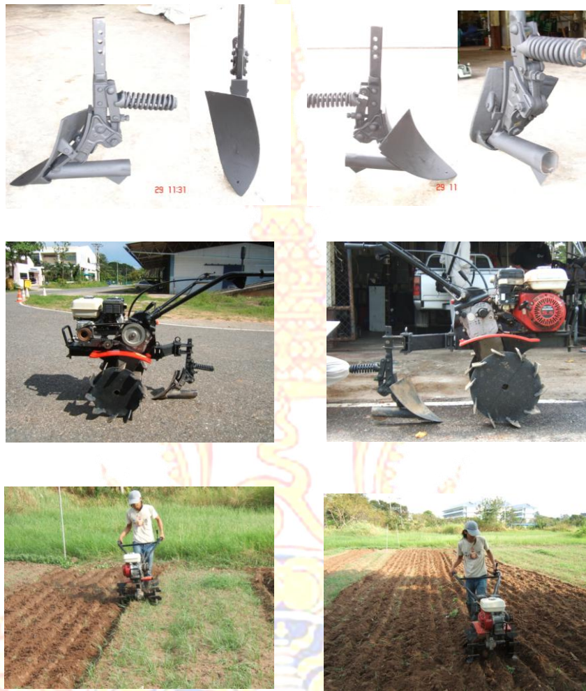
ภาพที่ 2 ลักษณะและการทำงานของไถหัวหมูติดรถไถเดินตาม
