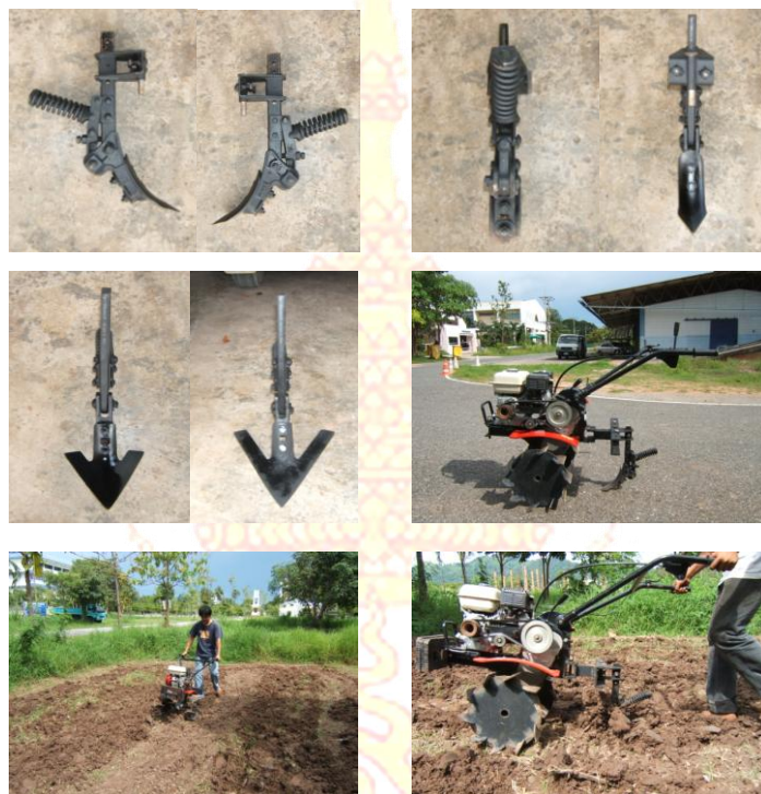
ภาพที่ 3 ลักษณะและการทำงานของไถลั่วติตรถไถเดินตาม
