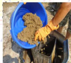
g. ล้างกากที่ต้มและนำใส่บีกอีก ครั้งเพื่อนำไปสู่ขั้นตอนการฟอกสี ด้วยไฮโดรเจนเปอร์ออกไซด์
