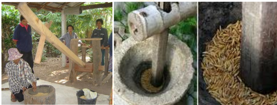
ภาพที่ 5 ลักษณะและวิธีการตำข้าวด้วยครกกระเดื่อง หรือครกมอ
