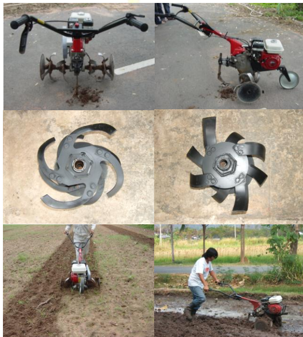
ภาพที่ 4 ลักษณะและการทำงานของเครื่องพรวนย่อยดินตีดรไถเดินตาม
