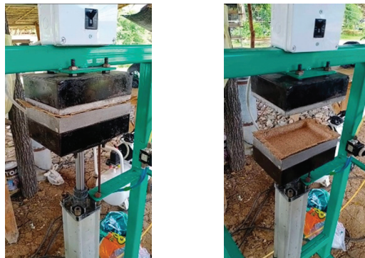
รูปที่ 1 การอัดขึ้นรูปด้วยความร้อนของการผลิตโฟมชีวภาพจากเส้นใยจากกล้วยและแป้งมันสำปะหลัง (พันธุ์ 81)
